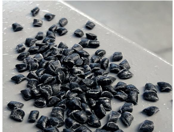
**Bild 1.** Für die Versuche wurde aus Organoblech-Verschnittabfällen auf Basis von UD-Tapes (links) ein Regranulat (rechts) hergestellt © PureLoop
